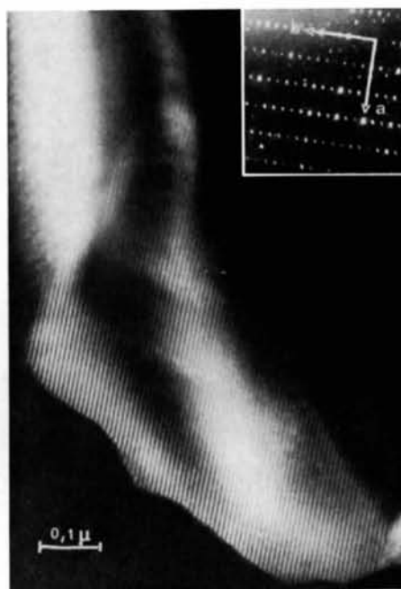
Fig. 6. Mise en évidence des plans équidistants de 37 Å dans un cristal de la phase de type bronze \text{Eu}_9\text{Ta}_{34}\text{O}_{94} par résolution directe.
